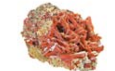
紅鉛鉱(Crocoite) 別名クロコイト、クロム酸鉛 Pb(CrO 4 ) かなり、名前のようにクロッカス色(鮮やかなオレンジ色)である。クロムが新しい元素として発見されたのは、この鉱物から。
